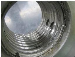
上記設備、切込み軸用に組み込まれたX軸ボールねじナット内に切削切子が混入し、回転異常が発生していました。循環部品破損には至っていませんでしたが、摩耗が発生し加工精度に影響を及ぼしていました。
