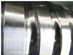
強いモーメント荷重を受けた状態の駆動によって異常発熱を起し、ボールねじが軸方向に膨張した結果、両端を固定するベアリングがスラスト荷重によって破損していました。
