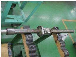
早送り時にストロークを超え、他部品に衝突。軸取付部に3mm程度の曲がりが発生しています。再稼働させるとねりを伴う異音が発生し、モーターへの過負荷も確認できました。
